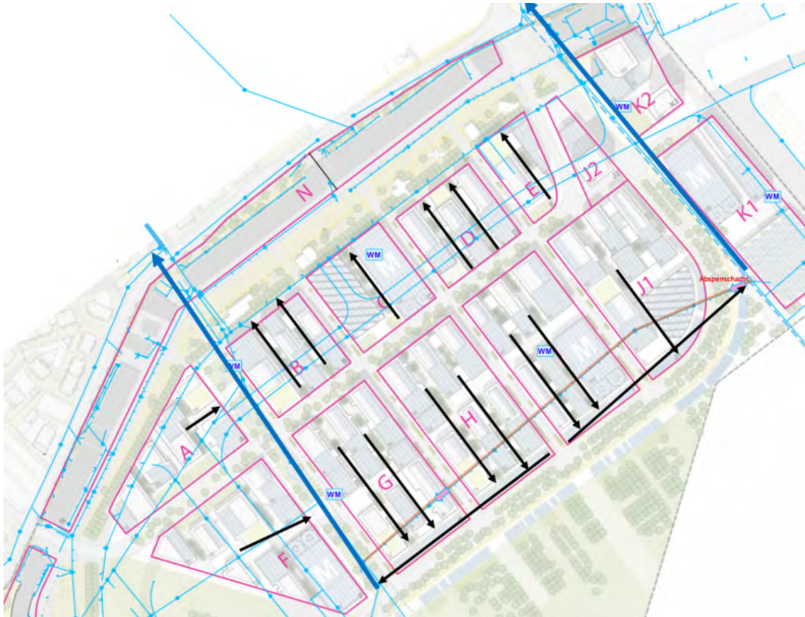
Abbildung 17: Planzustand Bauflächenentwässerung A (IPZ) (Quelle: [13]). Pinke Polygone stellen Bauflächen dar. Schwarze Pfeile geben die Abflussrichtung auf den Böden der Bauflächen an.
