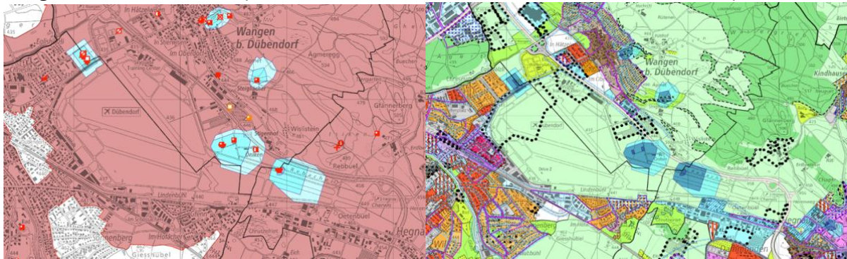
Bild 13: Gewässerschutzkarte und Zonenplan mit den Grundwasserschutzzonen Eglishölzli, Stiegenhof und Widacher (Quelle: GIS-ZH, Screenshot Cla Semadeni 02.05.2023)
