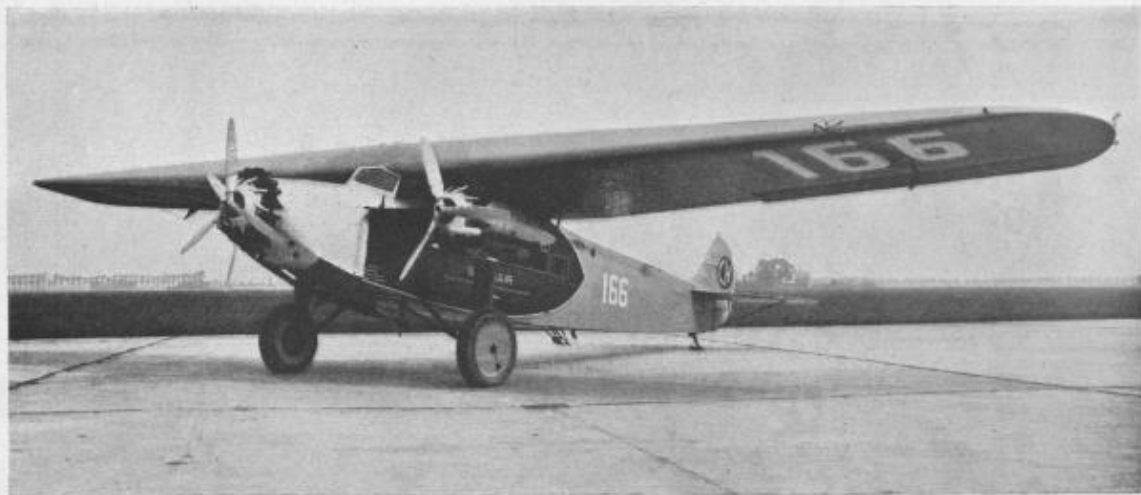
Ein neuer zehnplätziger Fokker (3 Wright, 900 PS) der Swissair. Un nouveau Fokker (3 moteurs Wright 900 CV.) à 10 places de la Cie. Swissair.
