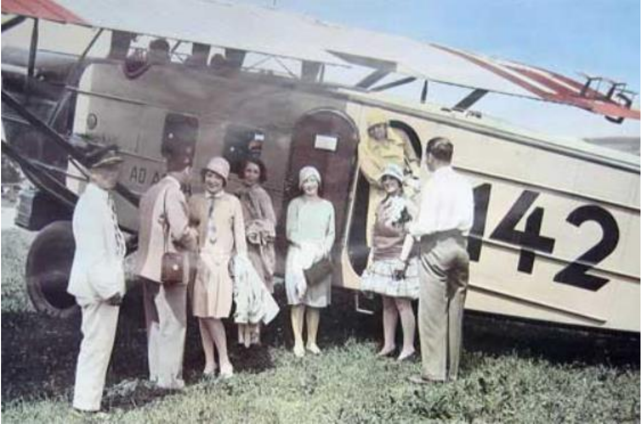
Dornier Merkur CH-142 der Ad Astra Aero (zirka 1927) beförderte max. 7 Passagiere mit 150 km/h
