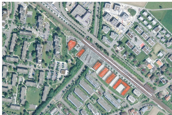
Verlängerung der S-Bahnhaltestelle Nänikon-Greifensee als Alternative zur S-Bahnhaltestelle Milandia. Mögliche städtebauliche Disposition mit einem Platz auf dem Niveau der Greifenseestrasse.
