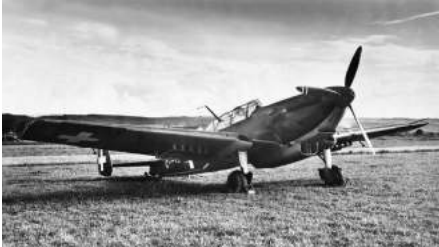
Abbildung 50: 1942 wird auf dem „ Militärflugplatz Dübendorf “ eine C-36 der Schweizer Flugwaffe, die 1939 in Thun ihren Erstflug absolviert hatte, mit einem von Ackeret konzipierten Verstellpropeller umgerüstet
